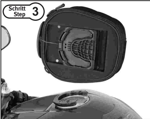
Nehmen Sie nun den EVO Tankrucksack MIT dem EVO Oberring vom EVO Tankring. Achten Sie darauf, den EVO Oberring unter dem EVO Tankrucksack in Position zu halten.
