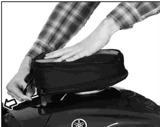
Um den EVO Tankrucksack zu lösen, einfach den Pull-Riemen ziehen.
