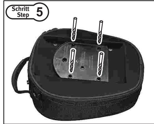
Nutzen Sie einen 8-mm-Bohrer, um die Montagelöcher von der Außenseite des EVO Tankrucksacks zu bohren. Bohren Sie durch die Öffnungen der Bohrschablone (3) wie gezeigt. Bitte beim Bohren ein Holzstück auf der Gegenseite unterlegen! Falls die Verwendung des EVO Schloss-Kit vorgesehen ist, muss der EVO Tankrucksack an der mittleren Bohrposition "Diebstahlsicherung" der Bohrschablone (3) mit einem 5,5-mm-Bohrer aufgebohrt werden.
