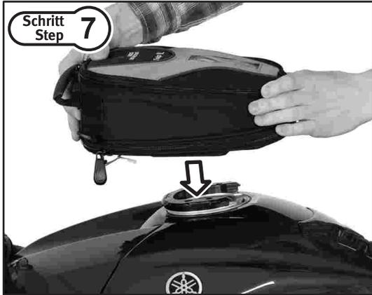
Setzen Sie den EVO Tankrucksack mit montiertem EVO Tankoberring von oben auf den EVO Tankring.
