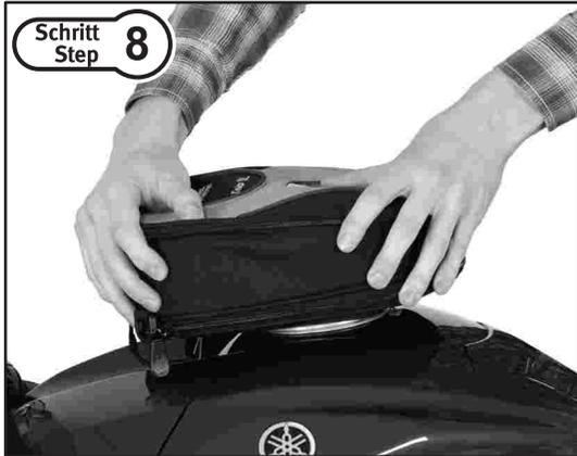
Drücken Sie den EVO Tankrucksack feste auf den EVO Tankring. Achten Sie auf das deutlich hörbare Einrastgeräusch. Prüfen Sie anschließend den festen Sitz des EVO Tankrucksacks.
