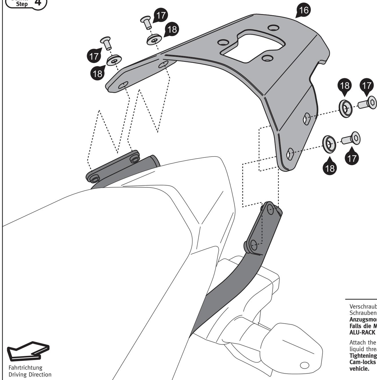
Verschrauben Sie das ALU-RACK (16) auf den Auslegern (7) wie gezeigt. Sichern Sie die Schrauben (17) mit flüssiger Schraubensicherung.
