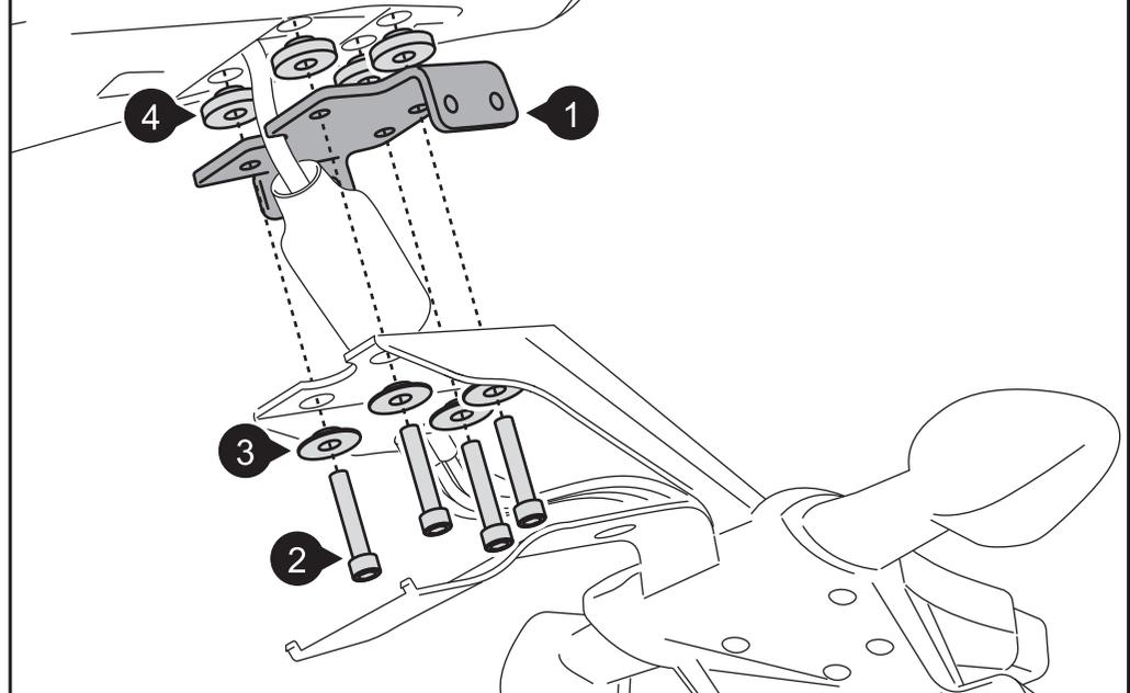
Verschrauben Sie nun den Querverbinder (1) zwischen Fahrzeug und Nummernschildhalter, wie in der Zeichnung gezeigt. Achten Sie auf die Ausrichtung der Bundbuchsen (3) und (4).
