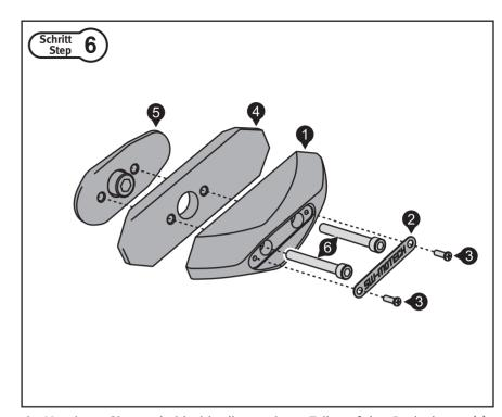
**6.-** Montieren Sie nun beidseitig die gezeigten Teile auf den Basisplatten (5). Bitte verwenden Sie flüssige Schraubensicherung, um die Schrauben (6) zu sichern.
