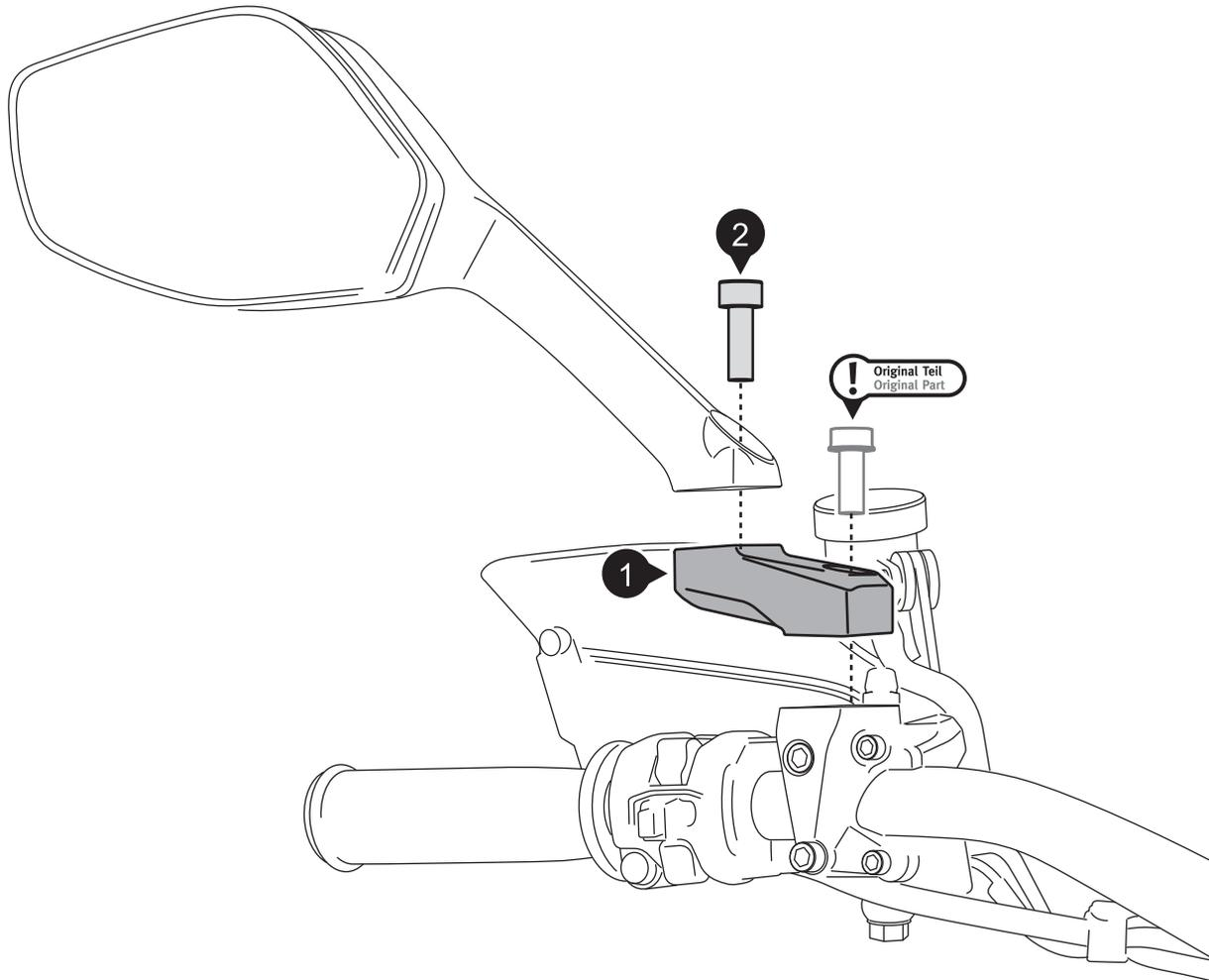
**! Schrauben mit flüssiger Schraubensicherung montieren!**
