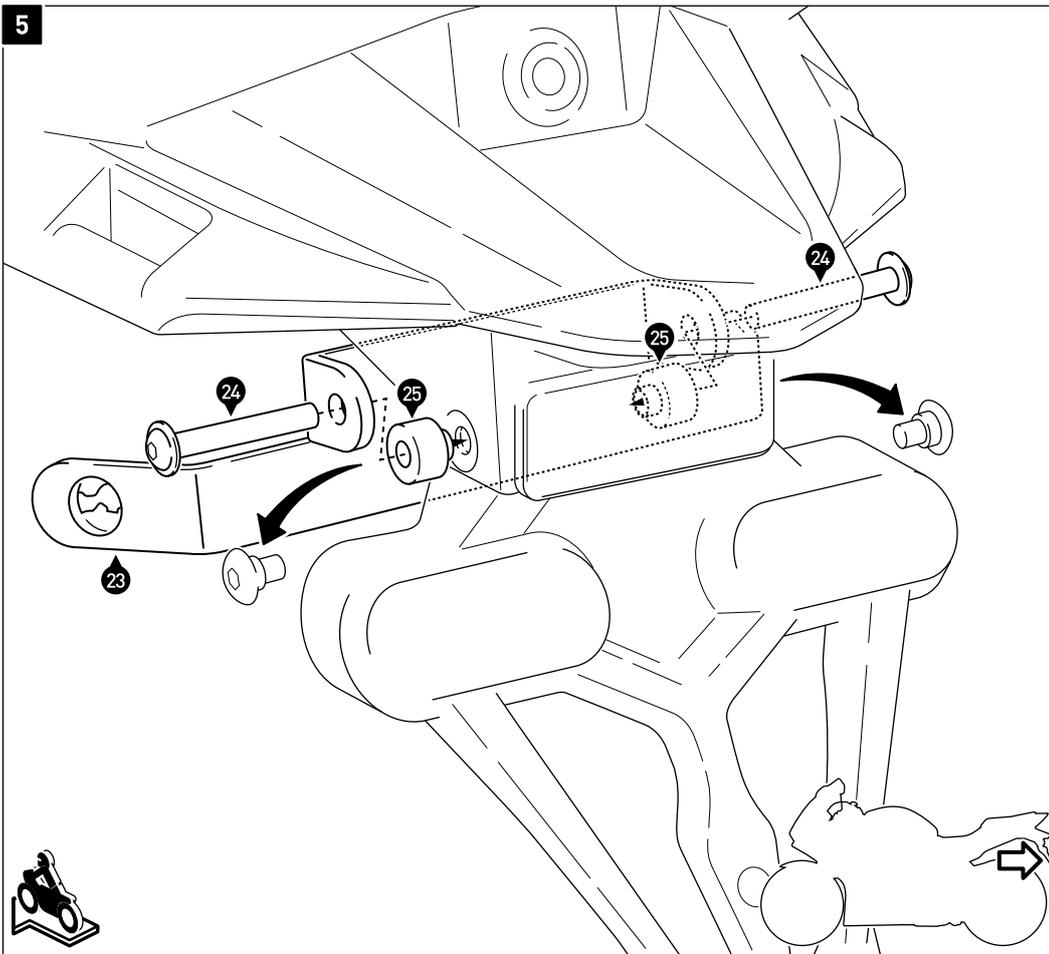
Entfernen Sie die originalen Schrauben vom Kennzeichenhalter.
