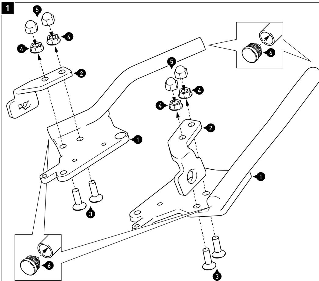
Verschrauben Sie die Befestigungslaschen (2) an den Haltegriffen (1), wie in der Zeichnung gezeigt. Ziehen Sie die Schrauben wie in der Stückliste vorgegeben an.
