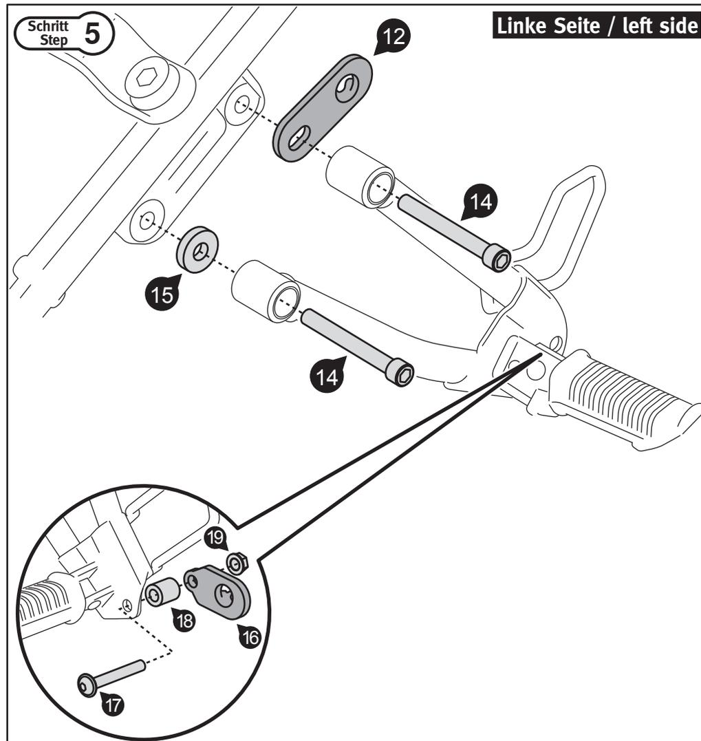
Verschrauben Sie die gezeigten Befestigungsbleche (12) und (16) mit der linken Soziousfußraste. Benutzen Sie flüssige Schraubensicherung. Ziehen Sie die Schrauben noch nicht an.
