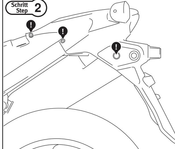
Entfernen Sie die Gummiabdeckung vom Gepäckträger. Lösen Sie die in **Schritt 1** gezeigten originalen Schrauben und entfernen Sie den Gepäckträger vom Fahrzeug. Lösen Sie anschließend beidseitig die in **Schritt 2** markierten Schrauben und Kunststoffdübel der Radabdeckung und lösen Sie diese vom Fahrzeug. Nun können die originalen Blinker demontiert werden.
