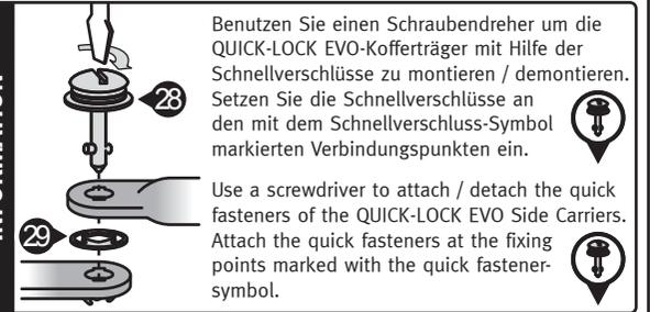
Benutzen Sie einen Schraubendreher um die QUICK-LOCK EVO-Kofferträger mit Hilfe der Schnellverschlüsse zu montieren / demontieren. Setzen Sie die Schnellverschlüsse an den mit dem Schnellverschluss-Symbol markierten Verbindungspunkten ein.
