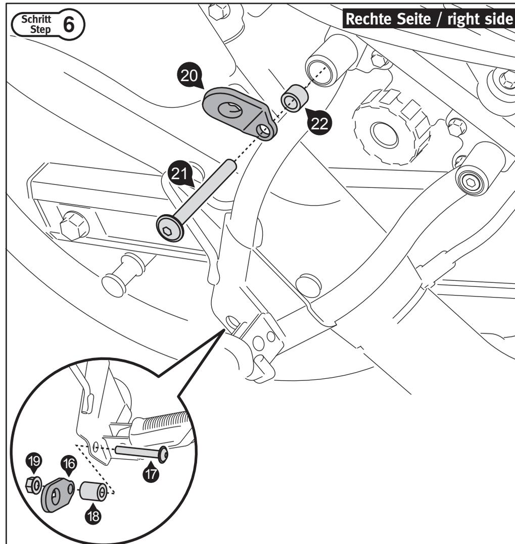
Verschrauben Sie die gezeigten Befestigungsbleche (16) und (21) mit der rechten Soziousfußraste. Benutzen Sie flüssige Schraubensicherung. Ziehen Sie die Schrauben noch nicht an.
