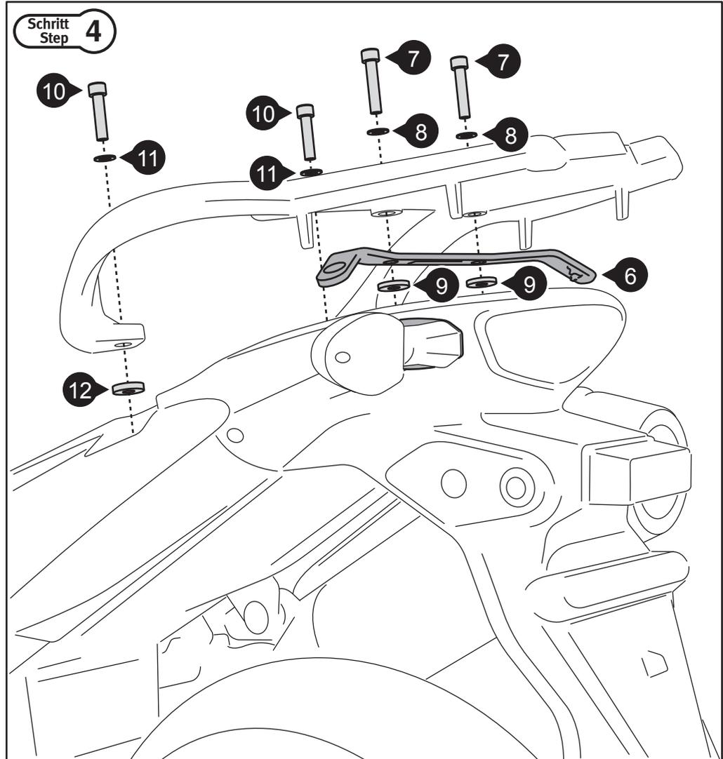
Montieren Sie den Gepäckträger mit dem oberen Querverbinder (6) am Fahrzeug. Benutzen Sie flüssige Schraubensicherung.
