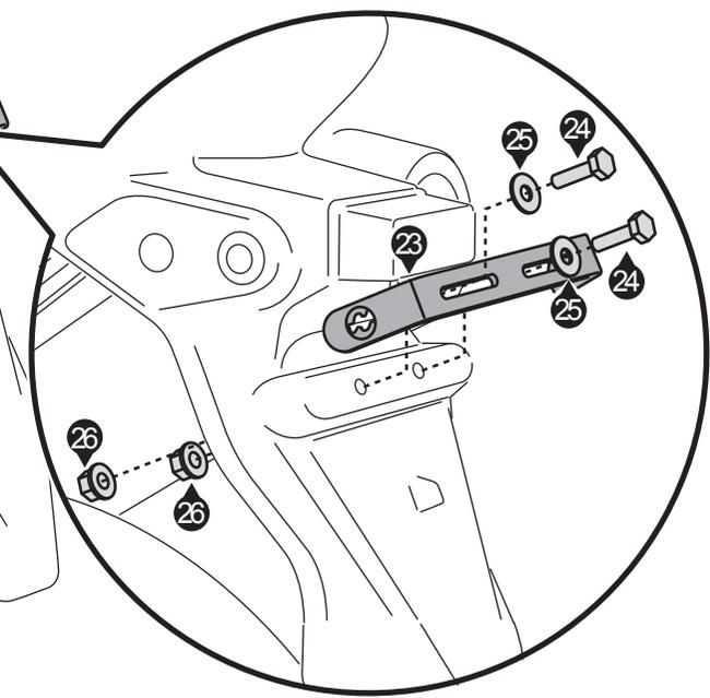
Verbinden Sie die Kofferträger (27) mit Hilfe der Schnellverschlüsse (28) mit den bereits montierten Befestigungsblechen und Querverbindern. Dadurch ergibt sich die Montageposition des Querverbinders (23). Verschrauben Sie nun den hinteren Querverbinder (23) am Fahrzeug, wie im Detailbild gezeigt.
