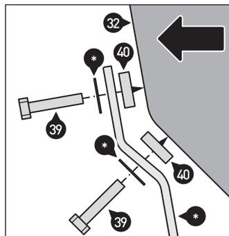
Wird der Motorschutz mit dem SW-MOTECH Sturzbügel verbaut, entfallen die Positionen (37) und (38). Montieren Sie den Motorschutz und Sturzbügel wie gezeigt (erst Motorschutz, dann Sturzbügel).
