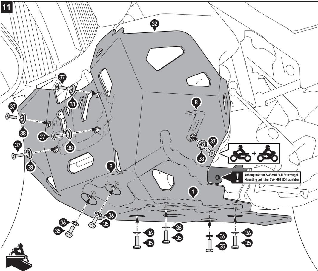
Verschrauben Sie den Motorschutz [32] an den Anbauwinkeln, Anbaublechen und den vorderen Aufnahmepunkten, wie in der Zeichnung gezeigt.
