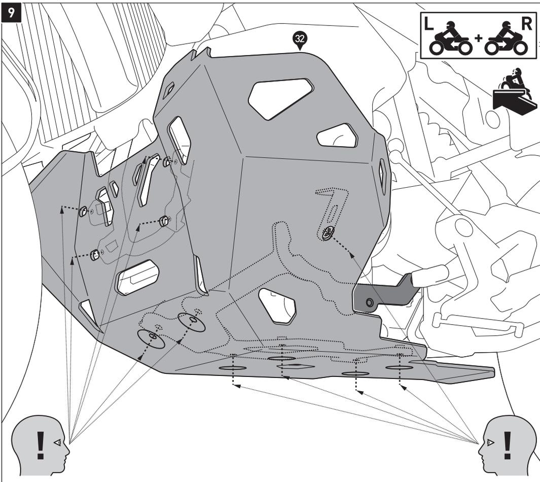
Drücken Sie mithilfe einer zweiten Person den Motorschutz (32) an alle zuvor montierten Anbauwinkel, Anbaubleche und die vorderen original Aufnahmepunkte.
