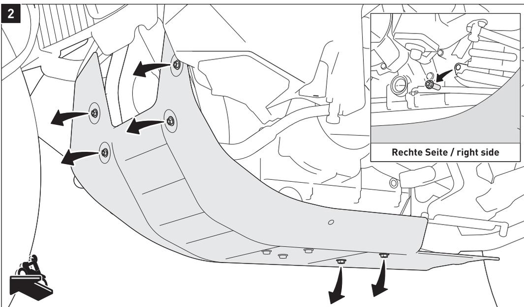
Entfernen Sie die im Detailbild gezeigte original Schraube auf der rechten Fahrzeugseite.
