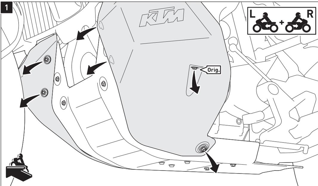
Lösen Sie beidseitig die gezeigten Schrauben und entfernen Sie die Tankverkleidungen vom Fahrzeug. Die mit (Orig.) markierten Schrauben werden in Schritt [4] benötigt.
