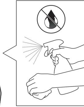
Reinigen Sie die Oberfläche des Motorschutzes (32) gründlich von Fett- und Schmutzrückständen.
