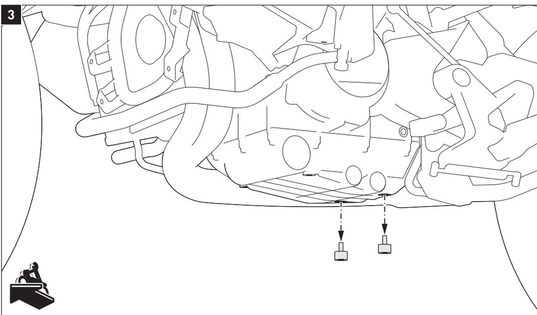
Entfernen Sie die gezeigten original Gummidämpfer.
