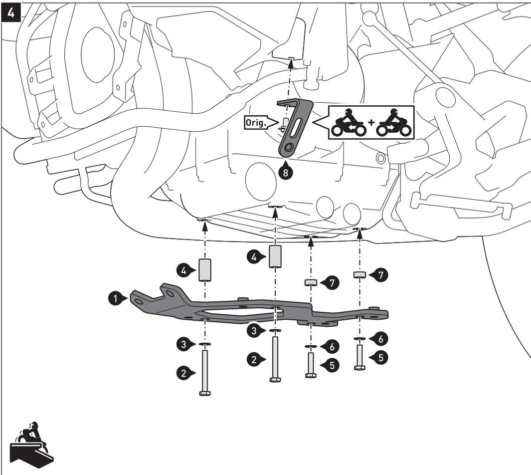
Verschrauben Sie das **untere** Anbaublech (1) und die Anbauwinkel (8) am Fahrzeug, wie in der Zeichnung gezeigt.
